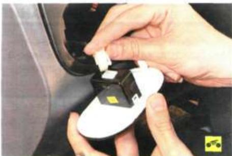
4. Отсоедините колодку жгута проводов и снимите регулятор электрокорректора света фар.
