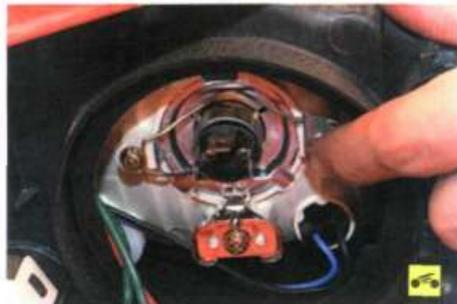
6. Выведите пружинный фиксатор из крючков на отражателе, откиньте фиксатор...
