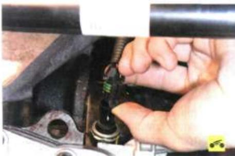
2. Отожмите фиксатор и отсоедините от датчика колодку жгута проводов.
