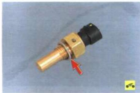
**Датчик температуры охлаждающей жидкости** установлен в системе охлаждения двигателя. Чувствительным элементом датчика является термистор, электрическое сопротивление которого изменяется обратно пропорционально температуре. При низкой температуре охлаждающей жидкости (-40 °С) сопротивление термистора составляет около 100 кОм, при повышении температуры до +130 °С — уменьшается до 70 Ом.
