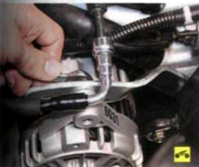
3. Окончательно выверните болт крепления генератора к натяжной планке.
