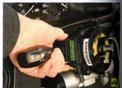
4. Сожмите фиксаторы и извлеките переключатель указателей поворота и света фар из соединителя.
