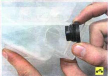
При установке сначала вставьте втулку в отверстие бачка, а затем установите насос.
