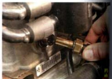
5. ...и выверните датчик из головки блока цилиндров.
