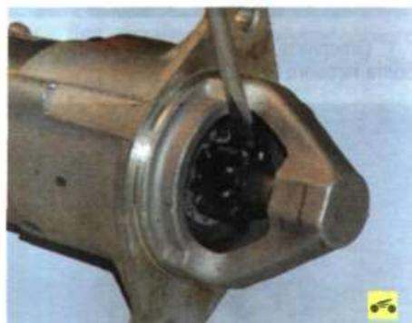
2. Проверните шестерню привода. Шестерня должна легко проворачиваться относительно ступицы муфты в направлении вращения якоря и не должна проворачиваться в противоположном направлении.
