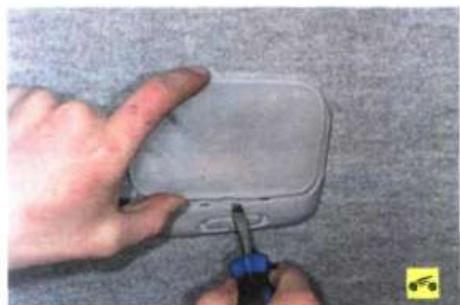
2. Отожмите отверткой фиксаторы и снимите рассеиватель плафона.
