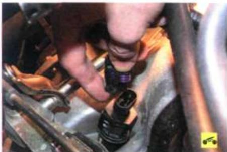
2. Отожмите фиксатор и отсоедините от датчика скорости колодку жгута проводов.
