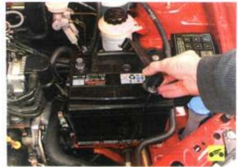
8. ...и снимите прижимную планку в сборе со стяжками.
