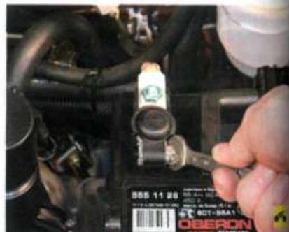
1. Ослабьте затяжку гайки стяжного болта наконечника провода...
