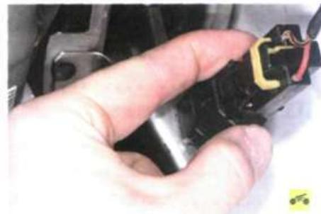
2. Поверните выключатель до совпадения фиксаторов с прорезями в кронштейне...
