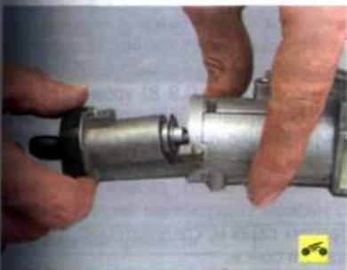
10. а) Извлеките цилиндр замка из корпуса ignition устройства.
