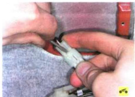
5. ...отожмите отверткой фиксатор, разъедините колодку жгута проводов и снимите плафон освещения салона.
