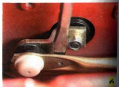
3. Используя отвертку как рычаг, отсоедините от кривошипа моторредуктора тягу привода стеклоочистителя.
