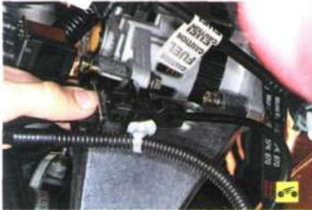
2. Сожмите фиксатор и разъедините колодку жгута проводов датчика положения коленчатого вала.
