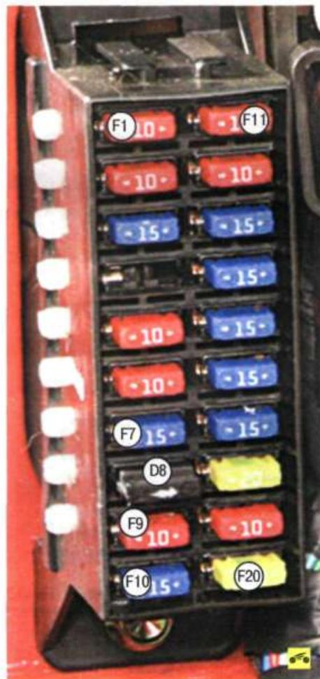
Рис. 10.1. Номера предохранителей в монтажном блоке, расположенном в салоне
