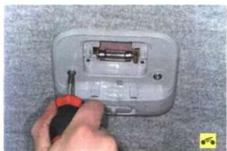
3. Выверните два винта крепления плафона...
