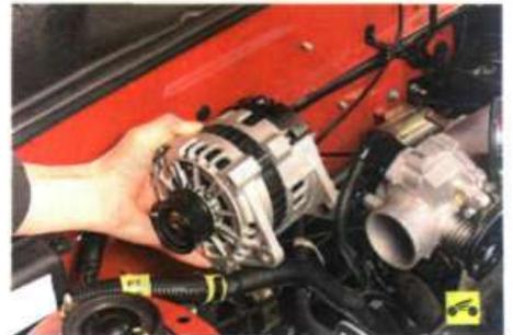
8. Извлеките генератор из подкапотного пространства.
