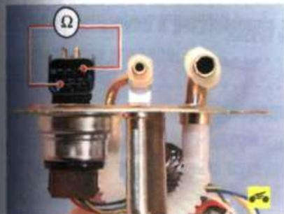
3. Подсоедините тестер в режиме омметра к выводам колодки топливного модуля.
