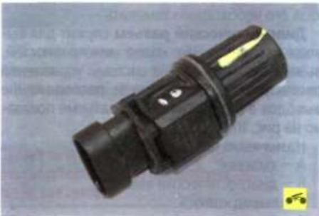
**Датчик скорости автомобиля** установлен на коробке передач. Принцип действия датчика основан на эффекте Холла. Датчик выдает на электронный блок управления прямоугольные импульсы напряжения с частотой, пропорциональной скорости вращения ведущих колес.
