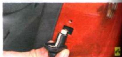
3. ...и извлеките выключатель из отверстия в кузове.
