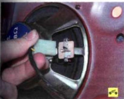
1. Отсоедините от динамика колодку жгута проводов (для доступа к колодке из салона автомобиля можно сложить заднее сиденье).
