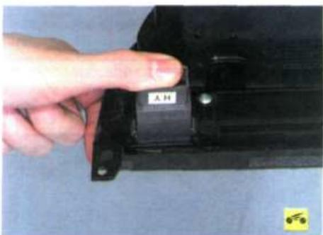
3. Надавите на выключатель с внутренней стороны облицовки и снимите его, преодолев усилие фиксаторов (для наглядности показано на снятой облицовке панели приборов).
