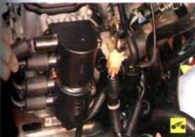
1. Отсоедините от выводов «1» и «4» катушки зажигания высоковольтные провода...
