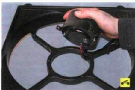
8. ...и снимите электродвигатель.
