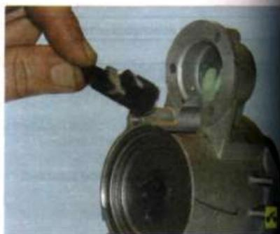
11. Извлеките опору рычага привода стартера.
