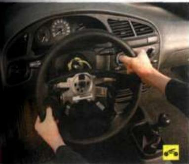
2. Снимите рулевое колесо (см. «Снятие и установка рулевого колеса», с. 176).
