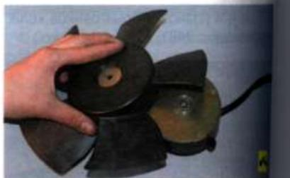
7. ...и снимите крыльчатку.
