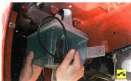
6. ...и снимите бачок омывателя в сборе с насосом.
