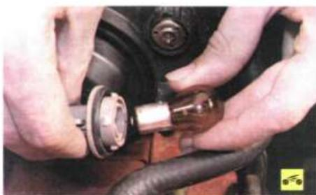
15. Нажмите на лампу, поверните ее против часовой стрелки и извлеките из патрона.
