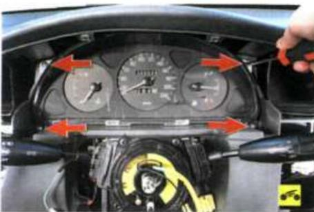
9. Выверните четыре винта крепления комбинации приборов...
