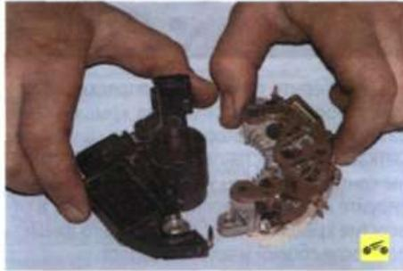
22. ...и отсоедините регулятор напряжения от блока.
