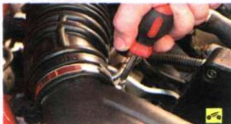
6. Ослабьте хомут крепления воздухоподводящего рукава к воздушному фильтру...
