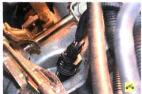
**Датчик скорости автомобиля** установлен на коробке передач. Датчик представляет
