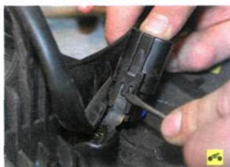
2. Отожмите отверткой фиксатор...
