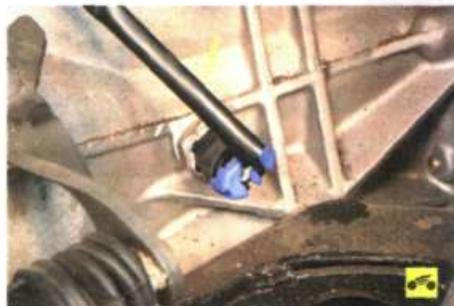
Выключатель света заднего хода установлен в верхней части картера коробки передач.
