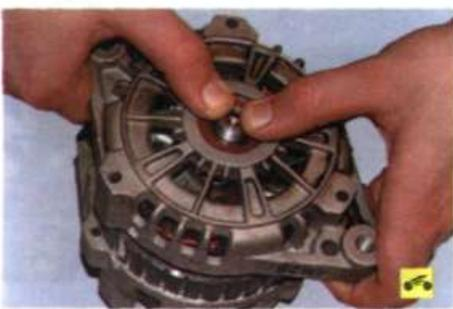
10. ...и снимите крышку со стороны привода.
