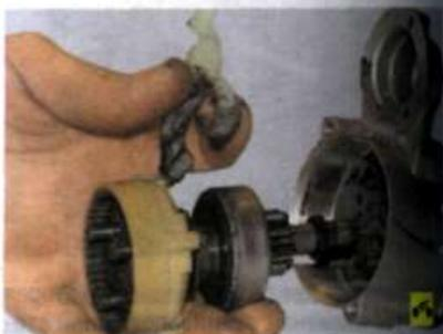
6. Извлеките вал привода и снимите рычаг.
