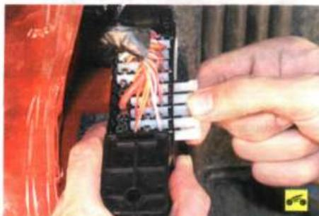
4. ...и снимите пластмассовый фиксатор контактной пластины.
