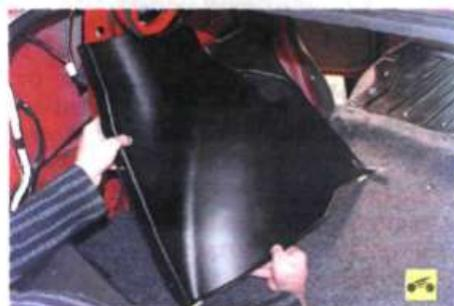
4. ...и левой арки заднего колеса (см. «Снятие и установка облицовок багажника», с. 279).
