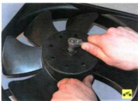
5. Отверните гайку крепления крыльчатки к валу электродвигателя...
