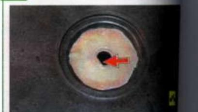
При установке следите за тем, чтобы выступ в отверстии крыльчатки совпал с точкой на валу электродвигателя.
