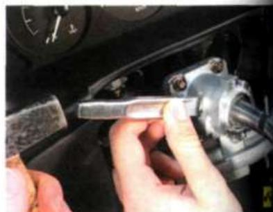
3. Выверните болт крепления выключателя, нанося удары молотком через зубило по часовой стрелке.
