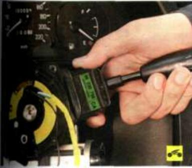
7. Сожмите фиксаторы, извлеките переключатель очистителя и омывателя ветрового стекла из соединителя...
