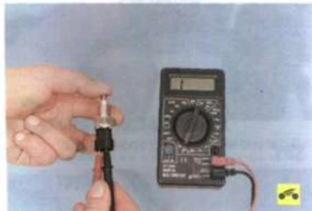
6. Для проверки выключателя подсоедините к его выводам тестер в режиме омметра. Сопротивление должно стремиться к бесконечности.
