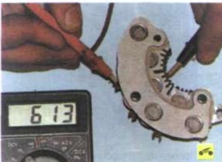
35. Проверьте выпрямительный блок. Для этого подсоедините щупы тестера к выводу фазной обмотки статора и воздушному радиатору диодов. Меняя щупы тестера местами,
