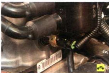
Датчик температуры охлаждающей жидкости установлен в торце головки блока цилиндров со стороны 4-го цилиндра под катушкой зажигания.
