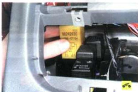
14. При необходимости замены извлеките реле из монтажного блока, покачивая его из стороны в сторону (на фото для наглядности снята облицовка панели приборов).
