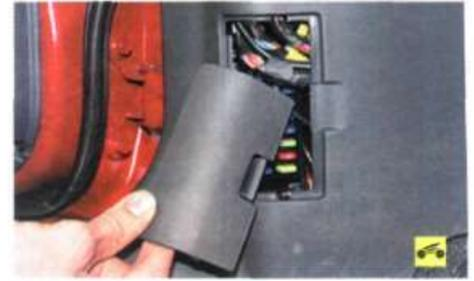
2. ...и снимите крышку в облицовке передней части боковины.
