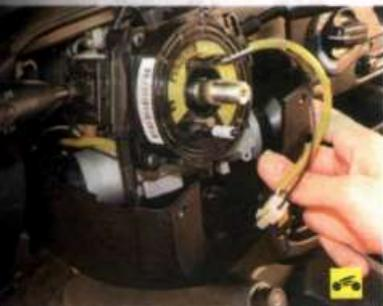
3. Снимите кожухи рулевой колонки (см. «Замена контактной группы выключателя (замка) зажигания», с. 218).
