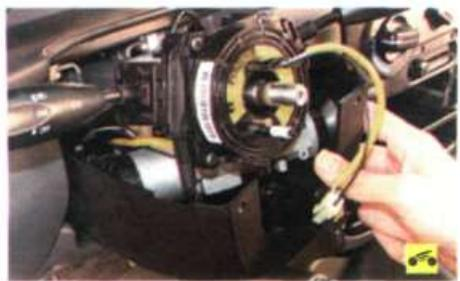
6. ...и нижнюю части кожуха рулевой колонки.
