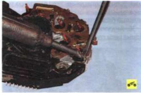
21. Отпаяйте выводы регулятора напряжения от выпрямительного блока...
