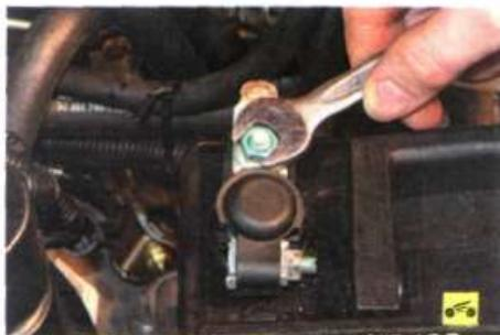
1. Отверните гайку крепления проводов...
