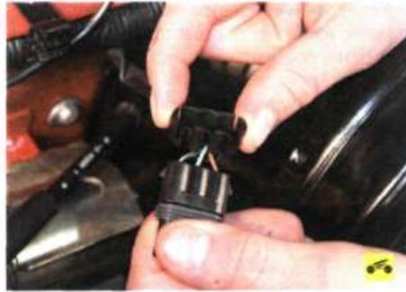
5. Снимите с колодки ее крышку, отжав фиксаторы, и подсоедините колодку к датчику.
