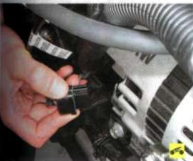
4. Отожмите фиксатор и отсоедините колодку жгута проводов от генератора.
