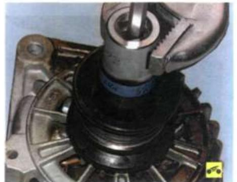
2. Удерживая ключом-шестигранником вал генератора, отверните гайку крепления шкива.
