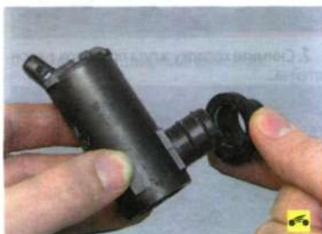
9. Снимите уплотнительную втулку.
