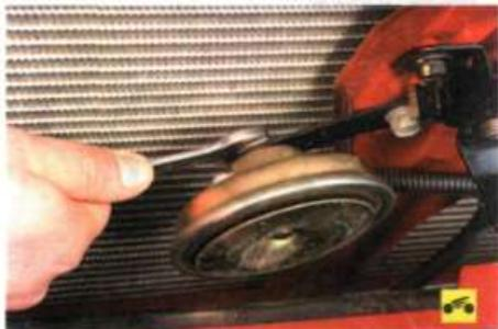
2. Отверните гайку крепления звукового сигнала.
