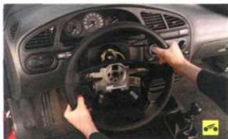
2. Снимите рулевое колесо (см. «Снятие и установка рулевого колеса», с. 176).
