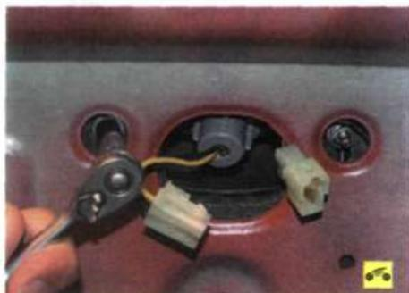
4. Отверните две гайки крепления...
