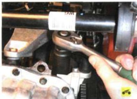
3. Выверните датчик из корпуса масляного насоса...
