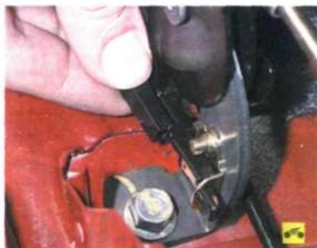
3. Отсоедините от выключателя колодку жгута проводов.
