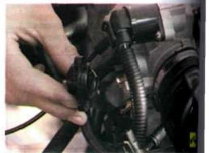
6. ...и снимите датчик положения дроссельной заслонки.
