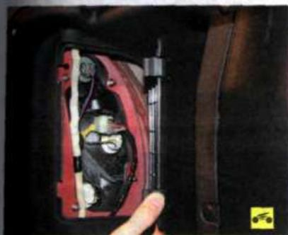
3. Сожмите фиксаторы и откройте крышку в облицовке багажника для доступа к заднему фонарю.
