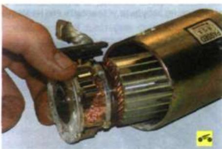
9. Извлеките из статора якорь в сборе со щеткодержателем.
