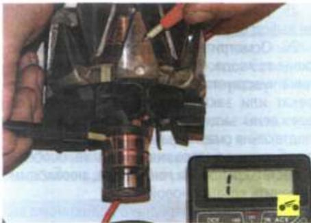
32. Проверьте замыкание обмотки ротора на «массу». Для этого подсоедините щупы тестера к полюсу ротора и поочередно к контактным кольцам. Измеренное сопротивление должно быть бесконечно большим, в противном случае замените ротор.
