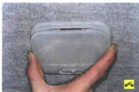
7. ...установите сначала переднюю часть рассеивателя в корпус плафона...
