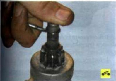
17. Поддев отверткой, снимите стопорное кольцо.
