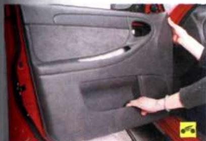
1. Снимите обивку двери и влагозащитную пленку (см. «Снятие и установка обивки передней двери», с. 252).
