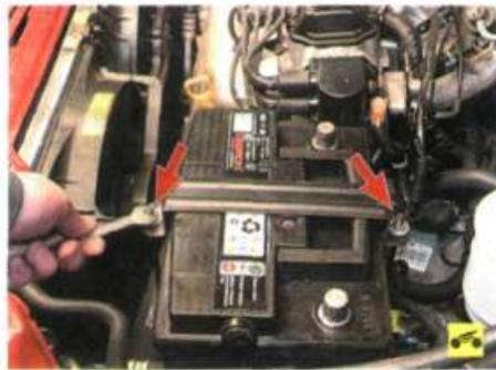
6. Ослабьте затяжку гаек крепления прижимной планки.
