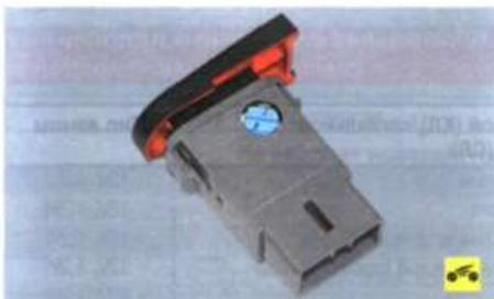
2. Снимите выключатель аварийной сигнализации.
