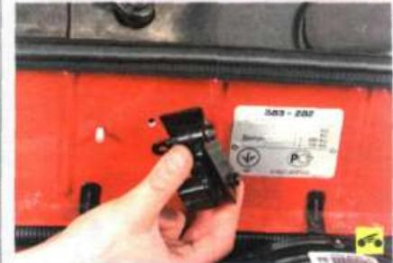
...и снимите датчик в сборе с кронштейном.
