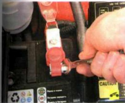
4. ...ослабьте затяжку гайки стяжного болта наконечника провода...
