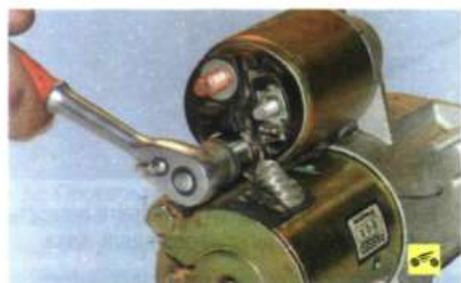
1. Отверните гайку нижнего контактного болта тягового реле...
