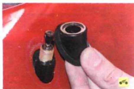
2. ...и снимите распорную втулку в сборе с резиновым уплотнителем.
