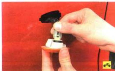
4. Поверните патрон против часовой стрелки...
