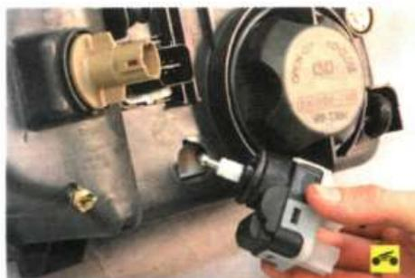
4. ...и извлеките его, выведя шаровой наконечник из зацепления с пластмассовым рычагом отражателя.
