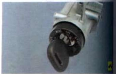
8. Вставьте ключ в выключатель (замок) зажигания и поверните его в положение «АСС».
