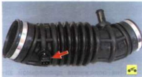
**Датчик температуры воздуха на впуске** (вклеен в воздухоподводящий рукав) аналогичен по конструкции датчику температуры
