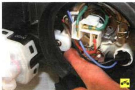
6. Установите электрокорректор в порядке, обратном снятию. При установке проследите, чтобы шаровой наконечник электрокорректора вошел в зацепление с рычагом отражателя, для чего снимите заднюю крышку блок-фары и придерживайте рычаг пальцем.
