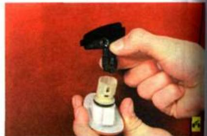
4. Сожмите фиксатор, отсоедините колодки жгута проводов от патрона лампы и снимите фонарь указателя поворота.
