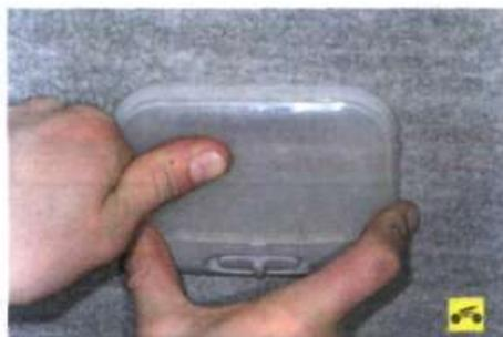
8. ...а затем нажмите на заднюю часть до щелчка (защелкивания фиксаторов).
