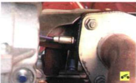
**Датчик концентрации кислорода** установлен на выпускном коллекторе. Датчик измеряет содержание кислорода в отработавших газах и преобразует измеряемую величину в напряжение сигнала, который подается на электронный блок управления двигателем. Используя сигналы датчика, контроллер управляет впрыском топлива таким образом, чтобы получить расчетный состав топливовоздушной смеси.
