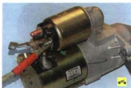
3. Соедините проводами для «прикуривания» клемму «минус» снятой с автомобиля аккумуляторной батареи с корпусом стартера. Второй провод подсоедините одним концом к клемме «плюс» аккумуляторной батареи, а другим — к выводу управляющего провода тягового реле. Если тяговое реле исправно, то раздастся щелчок и выдвинется муфта привода. В противном случае тяговое реле подлежит замене.
