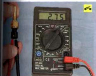
6. Подсоедините тестер к выводам датчика и измерьте сопротивление, а термометром измерьте текущую температуру.
