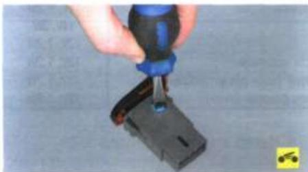
3. Поверните против часовой стрелки трон лампы...
