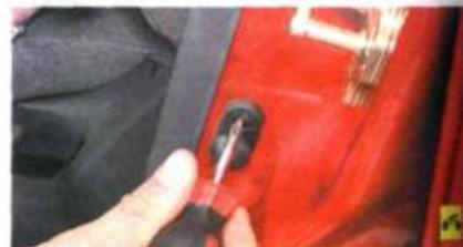
2. Выверните винт крепления выключателя к кузову автомобиля...
