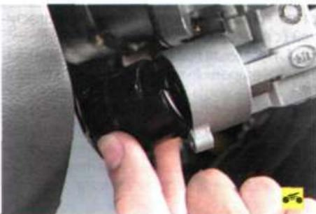
10. ...и снимите контактную группу замка зажигания.
