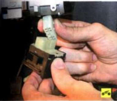
8. ...и отсоедините от него колодку жгута проводов, сжав ее фиксатор.
