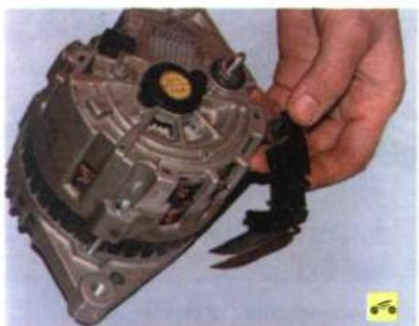
6. ...и снимите боковую защитную крышку.
