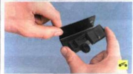
...и снимите датчик с кронштейна.
