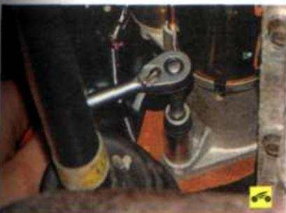
6. Отверните две гайки крепления (вторая гайка расположена с противоположной сто-
