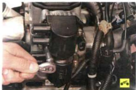
4. Отверните три гайки крепления...
