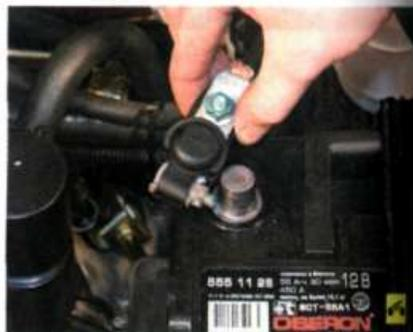
2. ...и отсоедините провод от клеммы «минус» аккумуляторной батареи.
