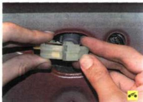
3. Сожмите фиксатор и разъедините колодку жгута проводов.
