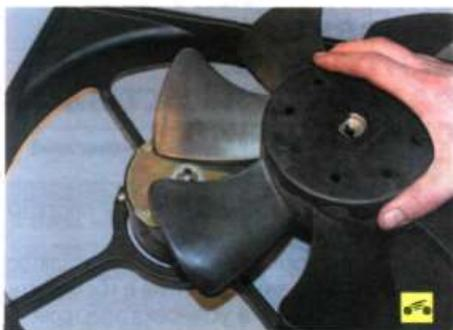
6. ...и снимите крыльчатку.
