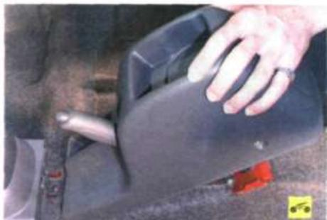
2. Снимите заднюю часть облицовки тоннеля пола (см. «Снятие и установка облицовки тоннеля пола», с. 265).
