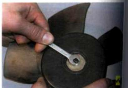
6. Отверните гайку крепления крыльчатки к валу электродвигателя...
