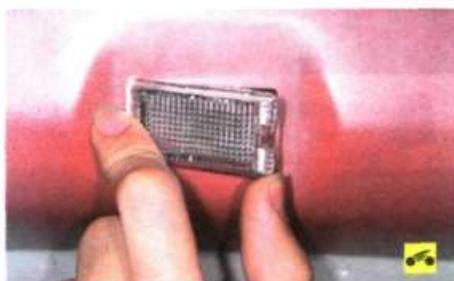
2. Преодолевая усилие фиксатора, извлеките плафон из отверстия в кузове автомобиля (при необходимости подденьте его отверткой).
