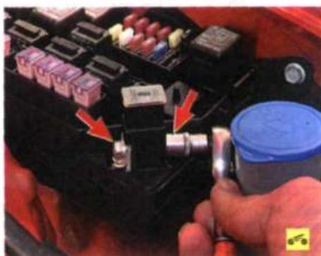
10. Для замены главного предохранителя №1 (см. рис. 10.2) выверните два болта...
