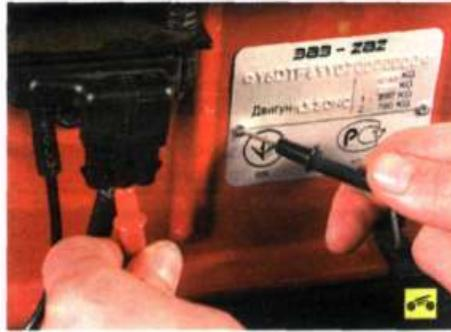
6. Подсоедините тестер в режиме вольтметра к проводу жгута, соединенному с выводом «В», и к «массе», пустите двигатель и измерьте напряжение датчика. При работе двигателя на холостом ходу напряжение должно составлять  $(1,3 \pm 0,4)$  В.
