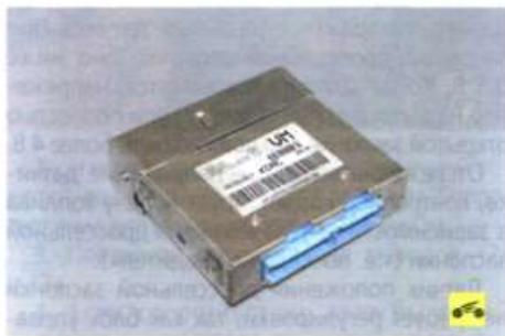
**Электронный блок управления (ЭБУ)** связан электрическими проводами со всеми датчиками системы. Получая от них информацию, блок выполняет расчеты в соответствии с параметрами и алгоритмом управления, хранящимися в памяти программируемого постоянного запоминающего устройства (ПЗУ), и управляет исполнительными устройствами системы. Вариант программы, записанный в память ПЗУ, обозначен номером, присвоенным данной модификации ЭБУ.
