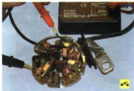
21. Осмотрите щеткодержатель. Проверьте высоту щеток в щеткодержателе. Если высота 7 мм и менее, замените щеткодержатель новым. Проверьте с помощью омметра изолированные держатели на замыкание с корпусом. Сопротивление должно стремиться к бесконечности.
