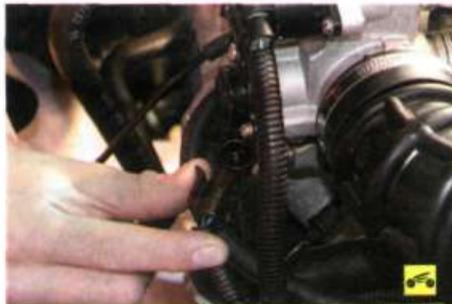
2. Отсоедините от датчика колодку жгута проводов, отжав фиксатор.
