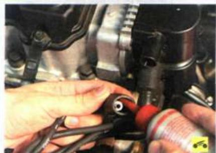
Перед установкой смажьте наконечники высоковольтных проводов консистентной смазкой, например техническим вазелином.
