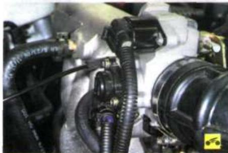
**Датчик положения дроссельной заслонки** представляет собой переменный резистор, который установлен на оси дроссельной заслонки. Вращение оси заслонки вызывает изменение напряжения сигнала датчика, по которому контроллер определяет степень открытия дроссельной заслонки.
