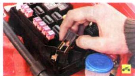
11. ...и снимите предохранитель.
