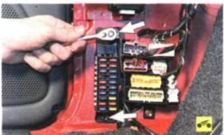
2. Выверните два болта крепления монтажного блока к кузову.
