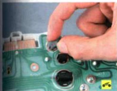
6. Для замены контрольной или сигнальной лампы поверните патрон против часовой стрелки...
