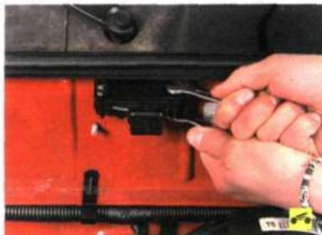
11. Удерживая болты от проворачивания, отверните две гайки крепления датчика и снимите его.
