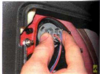
4. Поверните патрон лампы против часовой стрелки...
