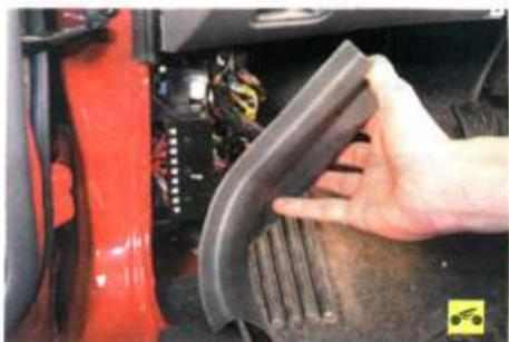
1. Для снятия монтажного блока предохранителей снимите облицовку левой передней боковины кузова (см. «Снятие и установка облицовок салона», с. 277).
