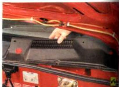
2. Снимите левую половину решетки корпуса воздухопритока (см. «Снятие и установка решетки корпуса воздухопритока», с. 250).
