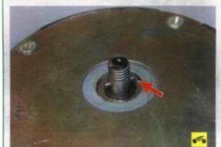
При установке следите, чтобы штифт вала электродвигателя попал в прорези отверстия крыльчатки.
