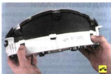
3. ...и четыре фиксатора в верхней части комбинации приборов...
