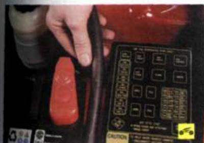
6. Для доступа к монтажному блоку, расположенному в моторном отсеке, извлеките паропроводящий шланг системы охлаждения из держателя на крышке монтажного блока и отведите его в сторону...
