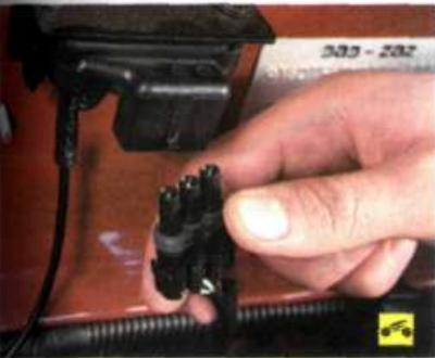
2. ...отсоедините колодку жгута проводов от датчика (при выключенном зажигании)...
