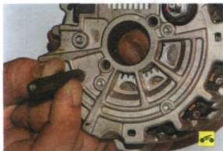
37. Соберите генератор в порядке, обратном разборке, сориентировав крышки генератора и корпус статора по ранее сделанным меткам. Перед установкой крышки со стороны контактных колец утопите щетки и зафиксируйте их в таком положении, вставив в отверстие крышки штифт подходящего диаметра. После сборки извлеките штифт.
