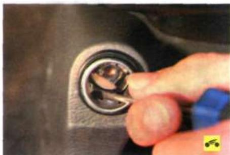
2. Отожмите отверткой фиксатор...
