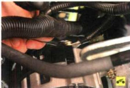
5. Отверните гайку крепления наконечника провода...
