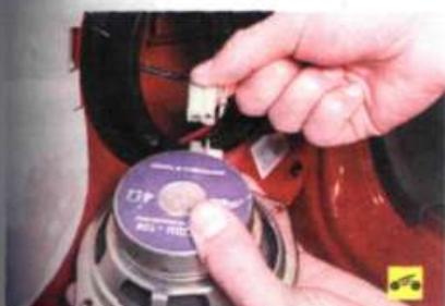
3. ...сжав фиксатор, отсоедините от динамика колодку жгута проводов и снимите динамик с автомобиля.
