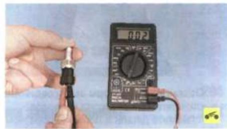
7. Нажмите на плунжер выключателя — сопротивление должно упасть до нуля. В противном случае выключатель неисправен и его необходимо заменить.
