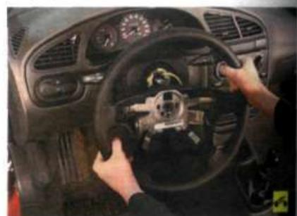
2. Снимите рулевое колесо (см. «Снятие и установка рулевого колеса», с. 176).
