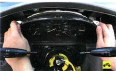
10. ...отведите ее от панели приборов, отсоедините три колодки жгута проводов и снимите комбинацию приборов с автомобиля.
