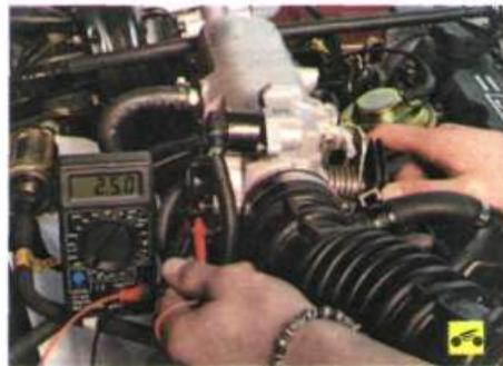
3. Подсоедините тестер в режиме измерения сопротивления к выводам «В» и «С» датчика и измерьте сопротивление при полностью закрытой дроссельной заслонке. Сопротивление должно составлять 1–3 кОм.
