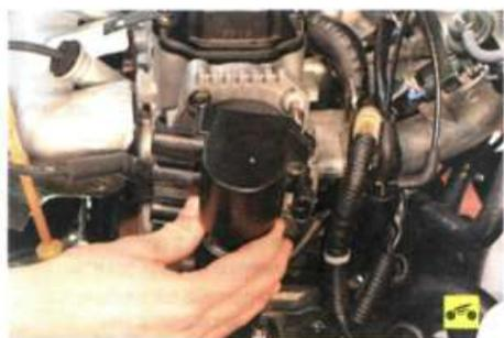
5. ...и снимите катушку зажигания.
