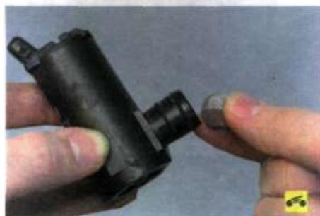
10. Извлеките из штуцера насоса сетчатый фильтр и промойте его при необходимости.
