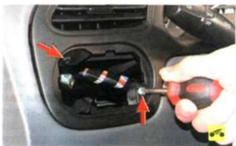
5. ...и выверните расположенные за ним два винта крепления облицовки.
