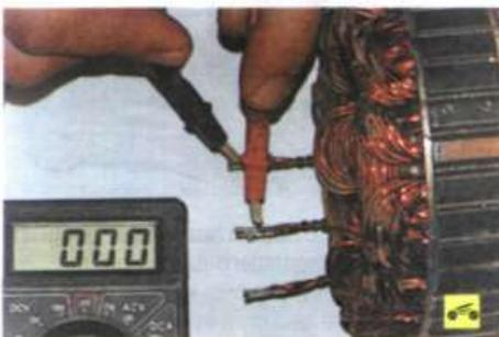
33. Проверьте обмотки статора на обрыв, поочередно измеряя тестером сопротивление между всеми выводами обмоток. Если измеренное сопротивление будет стремиться к бесконечности, то необходимо заменить статор.
