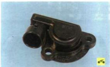
**Датчик положения дроссельной заслонки** установлен сбоку на дроссельном узле и связан с осью дроссельной заслонки.
