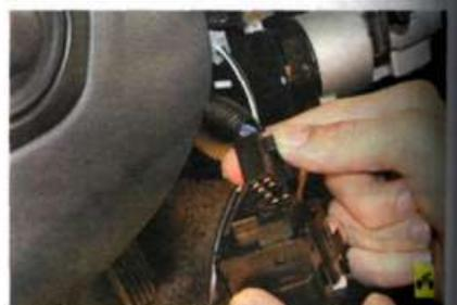
5. Сожмите фиксатор и отсоедините от переключателя колодку жгута проводов.
