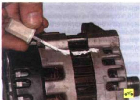
4. Пометьте взаимное расположение статора и крышек генератора.
