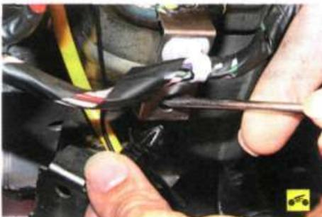
8. Отсоедините держатель хомута жгута проводов контактного кольца от кронштейна на рулевой колонке.
