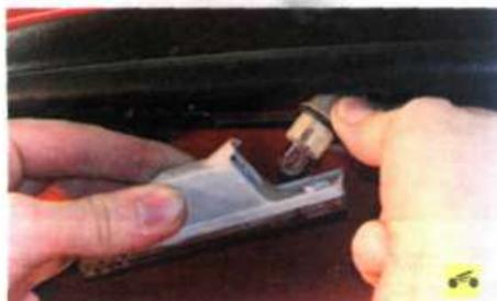
4. Поверните патрон лампы против часовой стрелки и извлеките его из фонаря освещения номерного знака.
