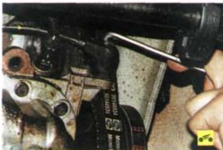
4. Выверните болт крепления датчика...
