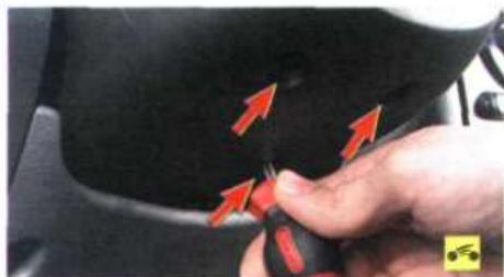
4. ...и три нижних винта крепления кожуха рулевой колонки.
