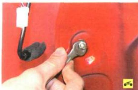
6. Отверните гайку крепления антенны к кузову...
