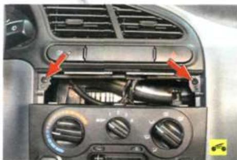
2. Снимите блок управления системой отопления и кондиционирования (см. «Снятие и установка блока управления системой отопления и кондиционирования», с. 275), не отсоединяя от него колодки жгута проводов; опустите немного вниз, чтобы получить доступ к винтам крепления облицовки панели приборов...
