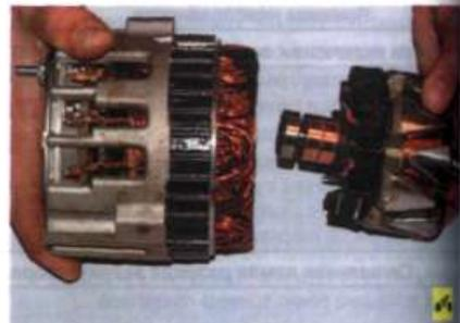
12. ...и выньте ротор из крышки со стороны контактных колец.
