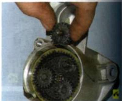
14. Снимите с осей водила три планетарные шестерни редуктора.
