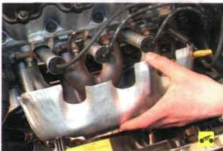
3. ...и снимите термозщит с выпускного коллектора.
