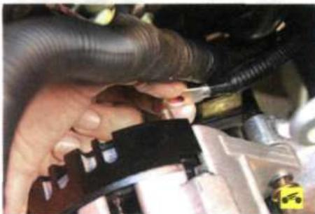
6. ...и отсоедините провод от вывода генератора.
