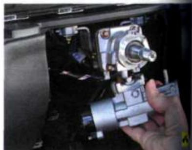
5. ...и снимите выключатель (замок) зажигания.
