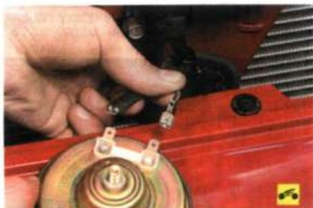
3. Отсоедините от звукового сигнала провод и снимите его.
