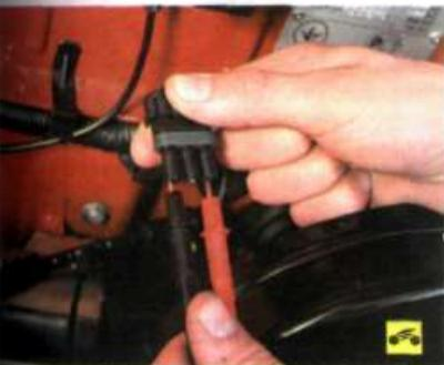
3. ...подсоедините тестер в режиме вольтметра к выводам «А» и «С» колодки (обозначения выводов нанесены на корпус колодки), включите зажигание и измерьте напряжение. Напряжение питания должно составлять  $(5,0 \pm 0,2)$  В.
