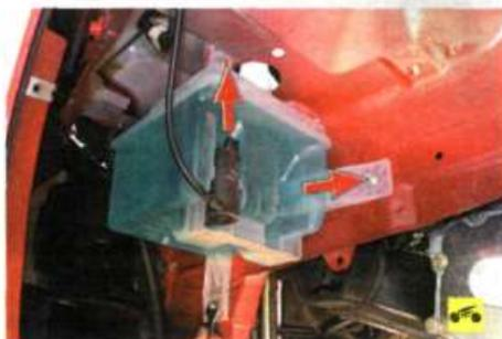
5. Отверните две гайки, выверните болт крепления...
