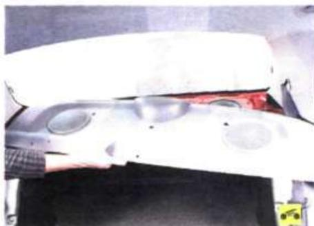
2. Снимите облицовку полки задка (см. «Снятие и установка облицовок салона», с. 277).
