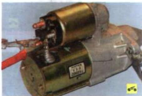
4. Отсоедините провод от управляющего вывода тягового реле и подсоедините к нижнему контактному болту тягового реле. Якорь
