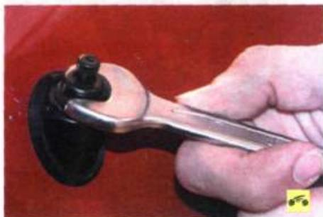
1. Отверните гайку крепления антенны к заднему крылу автомобиля...
