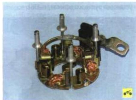
4. Перед установкой щеткодержателя на якорь разведите щетки и зафиксируйте любым доступным способом (например, заклепками или небольшими гвоздями). После установки щеткодержателя на якорь освободите щетки, убрав установленные фиксаторы.
