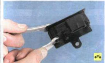
Удерживая болты от проворачивания, отверните две гайки крепления датчика...
