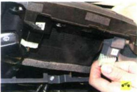
2. Выверните винты, отведите облицовку панели приборов (см. «Снятие и установка комбинации приборов», с. 238) и отсоедините колодку жгута проводов от заменяемого выключателя.
