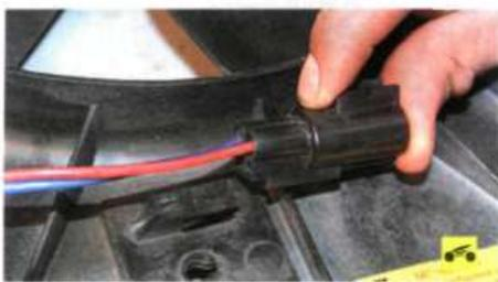
2. Снимите колодку жгута проводов с кронштейна...
