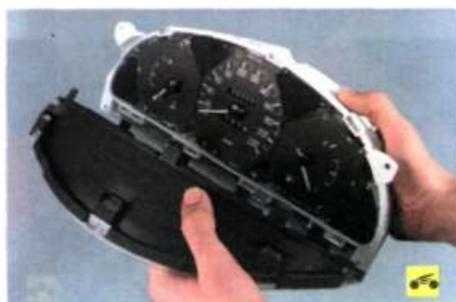
4. ...и снимите накладку комбинации в сборе со стеклом.
