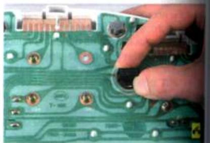
2. Для замены лампы подсветки прибора поверните ее патрон против часовой стрелки.
