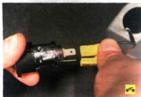
4. Отсоедините колодки жгута проводов и снимите патрон прикуривателя.
