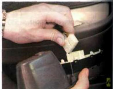
5. ...и отсоедините колодку жгута проводов от блока управления электростеклоподъемниками.
