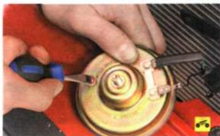
5. Нажмите на выключатель звукового сигнала (это должен сделать помощник) и, вращая регулировочный винт в ту или иную сторону, добейтесь громкого и чистого звучания звукового сигнала. Если этого не удалось сделать, замените звуковой сигнал.
