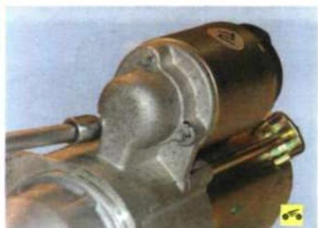
3. Выверните три болта крепления тягового реле к крышке стартера со стороны привода...
