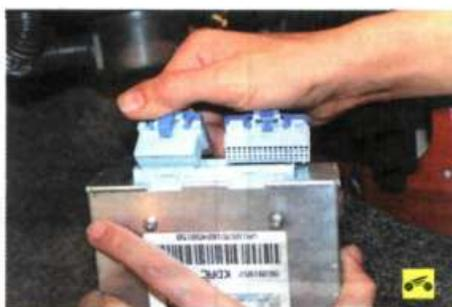
5. Отсоедините от ЭБУ колодку жгута проводов и снимите его с автомобиля.
