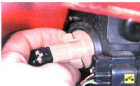
13. Поверните патрон лампы указателя поворота против часовой стрелки...
