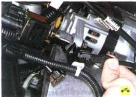
3. Извлеките колодку датчика положения коленчатого вала из держателя.
