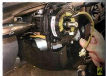
3. Снимите кожух рулевой колонки (см. «Замена контактной группы выключателя (замка) зажигания», с. 218).
