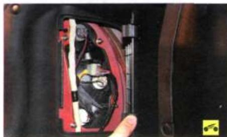
3. Сожмите фиксаторы и откройте крышку в облицовке багажника для доступа к фонарю.
