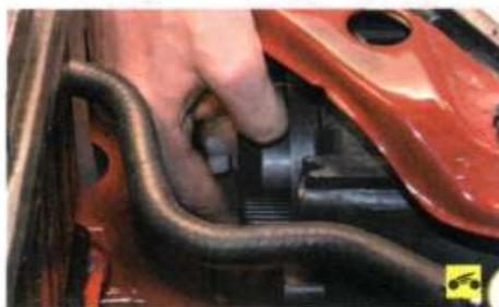
3. ...поверните крышку фары против часовой стрелки...
