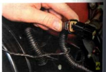
4. Сожмите фиксатор и отсоедините от моторредуктора колодку жгута проводов.
