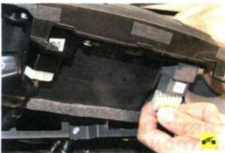
8. ...отсоедините колодки жгута проводов от выключателей и снимите облицовку панели приборов.
