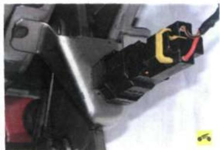
Выключатель стоп-сигнала установлен на кронштейне педали тормоза.
