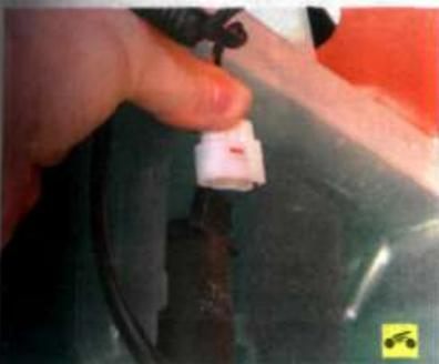
4. Отсоедините от насоса омывателя колодку жгута проводов.
