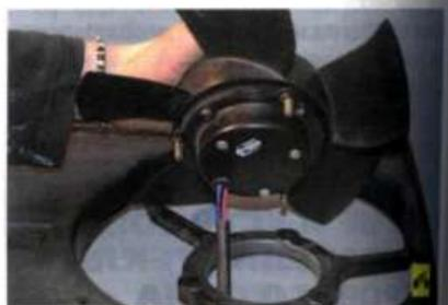
5. ...и снимите электродвигатель в сборе с крыльчаткой.
