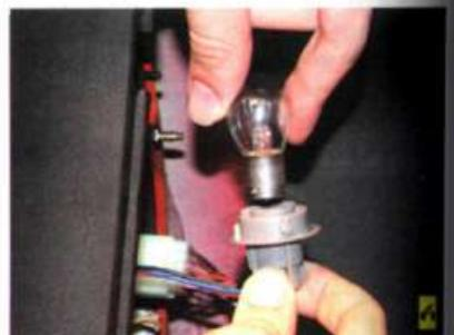
6. Нажмите на лампу, поверните ее против часовой стрелки и выньте из патрона.
