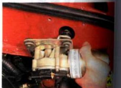
6. ...и снимите моторедуктор, сдвинув его вперед, чтобы извлечь кривошип из отверстия в кузове.
