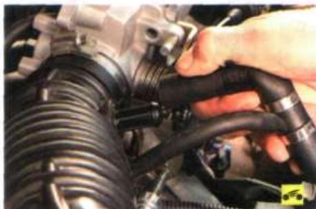
5. Отсоедините шланг вентиляции картера от штуцера воздухоподводящего рукава.
