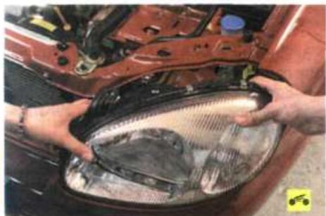
6. ...и снимите блок-фару с автомобиля.
