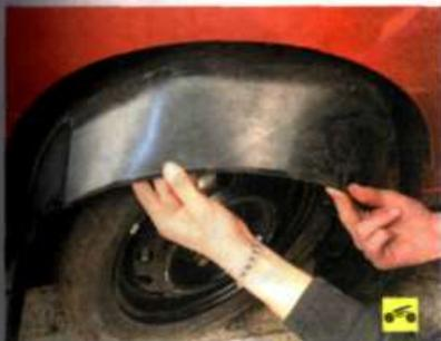
2. Снимите левый передний подкрылок (см. «Снятие и установка брызговиков колес и подкрылков», с. 248).
