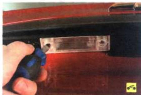
2. Выверните два винта крепления фонаря освещения номерного знака.
