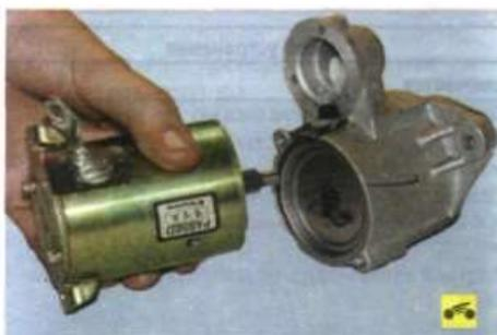
6. ...и разъедините статор и крышку со стороны привода.
