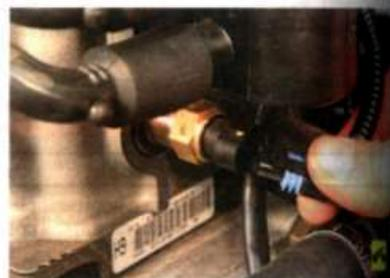
3. Отожмите фиксатор и отсоедините колодку жгута проводов от датчика температуры охлаждающей жидкости.
