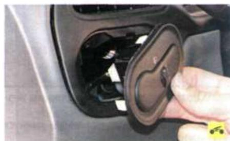
3. ...и извлеките из облицовки панели приборов регулятор...
