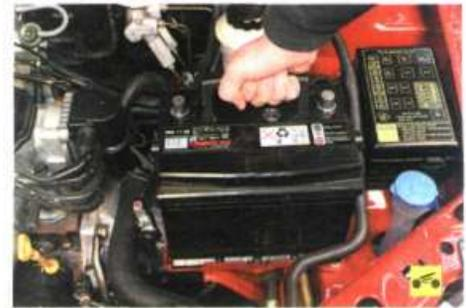
9. Снимите аккумуляторную батарею с автомобиля.
