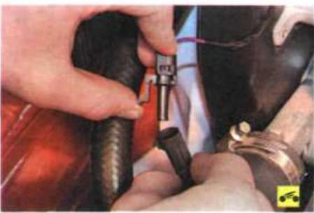
5. Отожмите фиксатор и разъедините колодку датчика концентрации кислорода.
