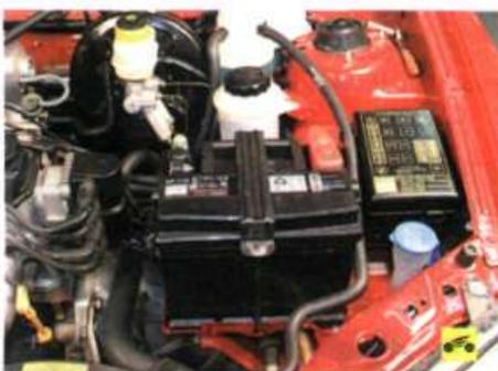
Завод-изготовитель устанавливает на автомобиле необслуживаемую аккумуляторную батарею номинальным напряжением 12 В, емкостью 55 А·ч. Элементы батареи расположены в полипропиленовом моноблоке и закрыты общей крышкой, неразделимо соединенной с моноблоком. В крышке батареи нет пробок, так как доливка дистиллированной воды не требуется. Два вентиляционных отверстия по бокам батареи в верхней части обеспечивают выход наружу небольшого количества газа, образующегося в батарее.
