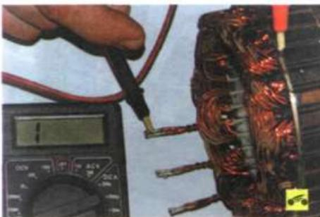
34. Подсоедините щупы тестера к корпусу статора и поочередно к каждому выводу обмоток. Измеренное сопротивление должно быть очень большим (стремиться к бесконечности). В противном случае замените статор.
