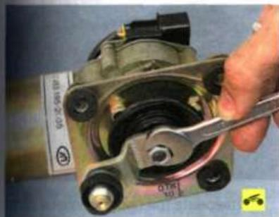
7. При необходимости отверните гайку крепления кривошипа и снимите кривошип, помня или запомнив его расположение на валу моторедуктора для корректной установки.
