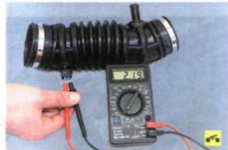
9. Подсоедините тестер в режиме омметра к выводам датчика и измерьте его сопротивление. Измерьте термометром текущую температуру воздуха и сравните полученные значения с табл. 10.6.
