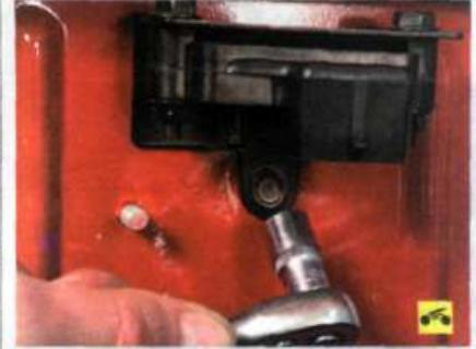
...выверните болт крепления кронштейна датчика...
