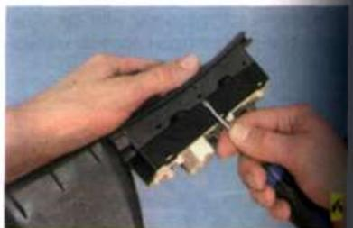
6. Отожмите отверткой фиксаторы.
