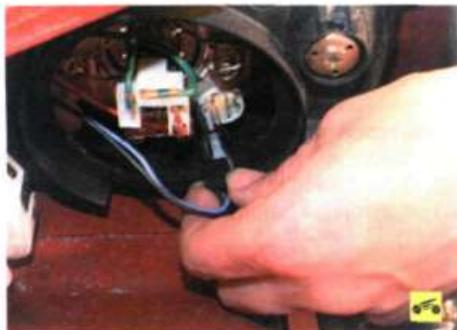
9. Вытяните патрон лампы габаритного света из гнезда (патрон установлен с небольшим натягом) и извлеките его из блок-фары.
