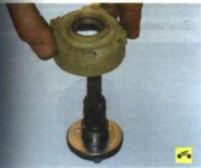
20. Снимите коронную шестерню планетарного редуктора.
