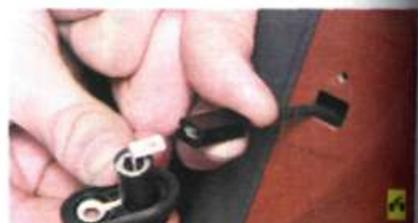
4. Отсоедините провод и снимите выключатель.
