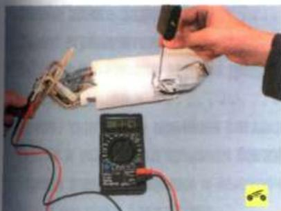
5. Поднимите рычаг с поплавком в крайнее положение — сопротивление должно уменьшиться почти до нуля. Если сопротивление
