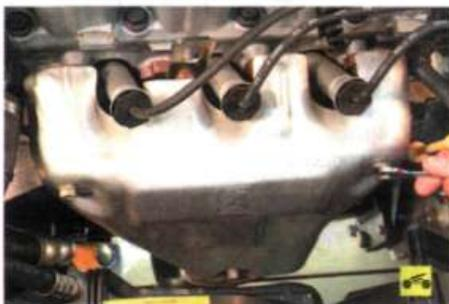
2. Выверните два верхних болта крепления термозщита, ослабьте нижний болт...
