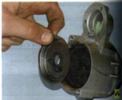
12. Снимите маслоотражательную крышку планетарного механизма...
